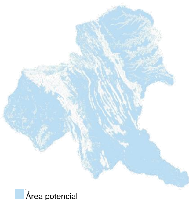
Figura1: Área do município de Unai potencial para uso de pivô central, com declividade inferior a 10%.
