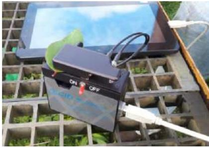
**Figura 1** - Mini espectrômetro foliar CI-710 (CID, Inc., Camas, Washington, USA).
