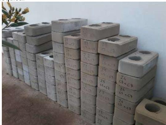
A absorção de água considera-se de vital importância para a durabilidade do tijolo, uma melhora das condições saudáveis e habitacionais da casa (evitando ter mofo no interior da habitação, ambiente interno menos úmido) e uma melhora de outros fatores como durabilidade de um possível revestimento ou pintura interior.
