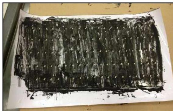
Figura 1. Produção das células eletroquímicas.
