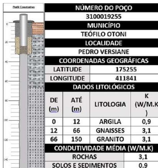
**Figura 3.** Perfil construtivo do poço 3100019255 localizado no município de Teófilo Otoni.
