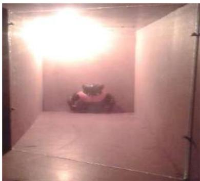
Ao diminuir a intensidade da lâmpada 1, que está sobre o boneco 1, aumentando simultaneamente, de forma lenta, a intensidade da lâmpada 2 (através do potenciômetro), que está sobre o boneco 2, observa-se uma transição de imagem entre os bonecos. No entanto, como esta transição ocorre num tempo muito curto, o cérebro interpreta esta informação como uma transformação, ou seja, um boneco “transformando-se” em outro (figura 5).
