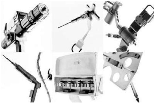
**Figura 3.** Equipamento PGT e equipamento para a remoção de arruelas e de parafusos usadas a missão de correção do telescópio espacial Hubble. (GIZMODO 2016).
