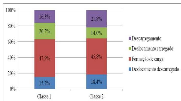
**Figura 5:** Distribuição percentual dos elementos do ciclo operacional do *Clambunk skidder*, para as duas classes de inclinação do terreno.
